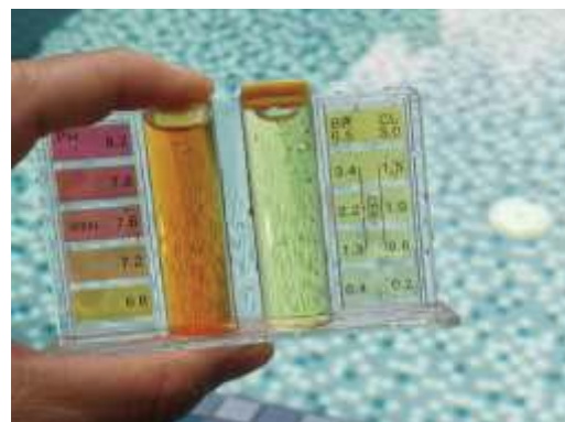
ตรวจวัดค่าความเป็นกรด-ด่าง และคลอรีน ภาพที่ 2.2-14 (ต่อ) การจัดการสระว่ายน้ำ
